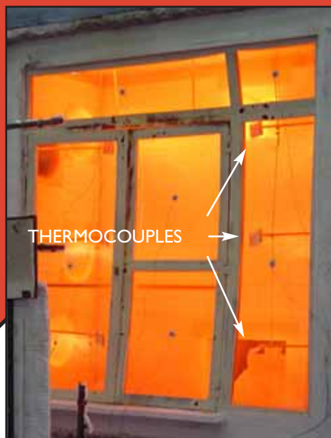
Essai au feu d'une cloison vitrée
